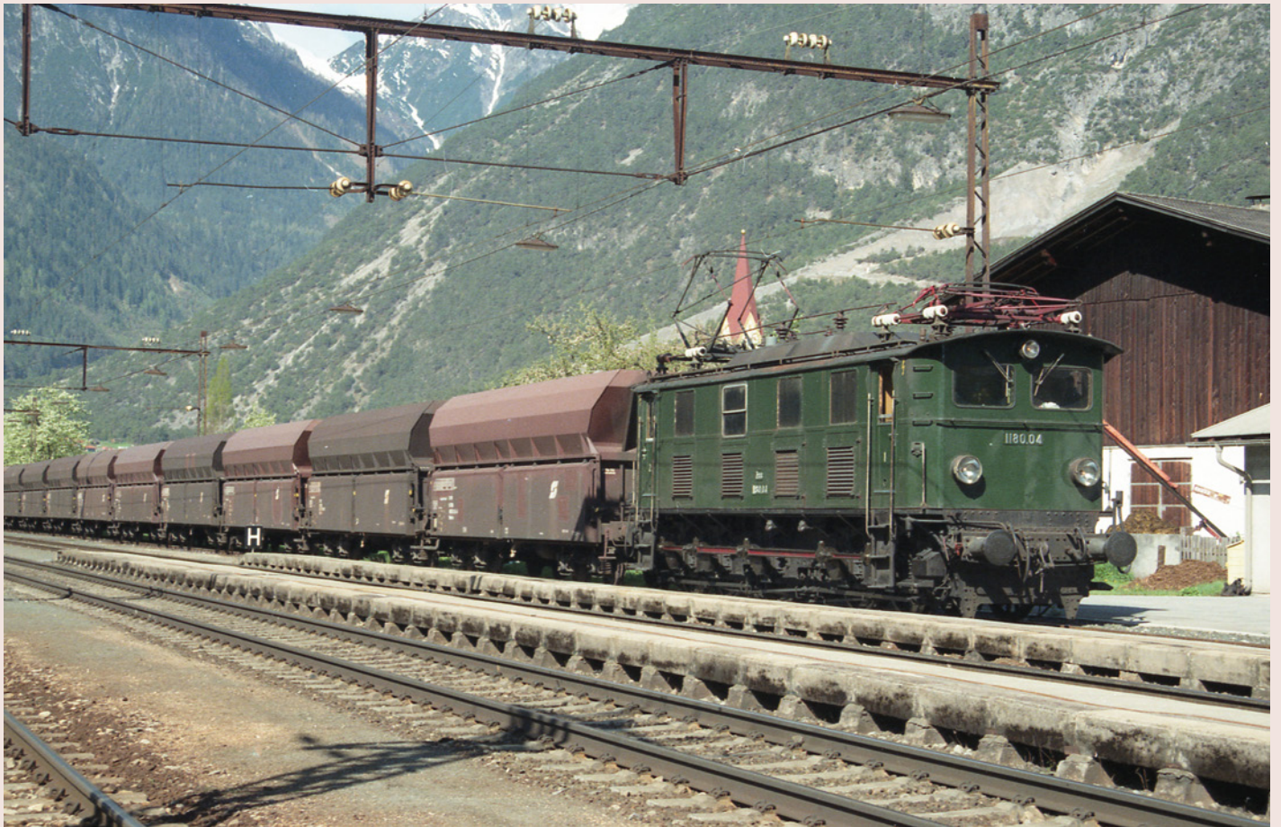
Die 1180.04 mit einem Erzwagenzug in Schönwies am 4. Mai 1996. Beachtenswert ist das Joch der alten Fahrleitung. Lothar Rihosek
