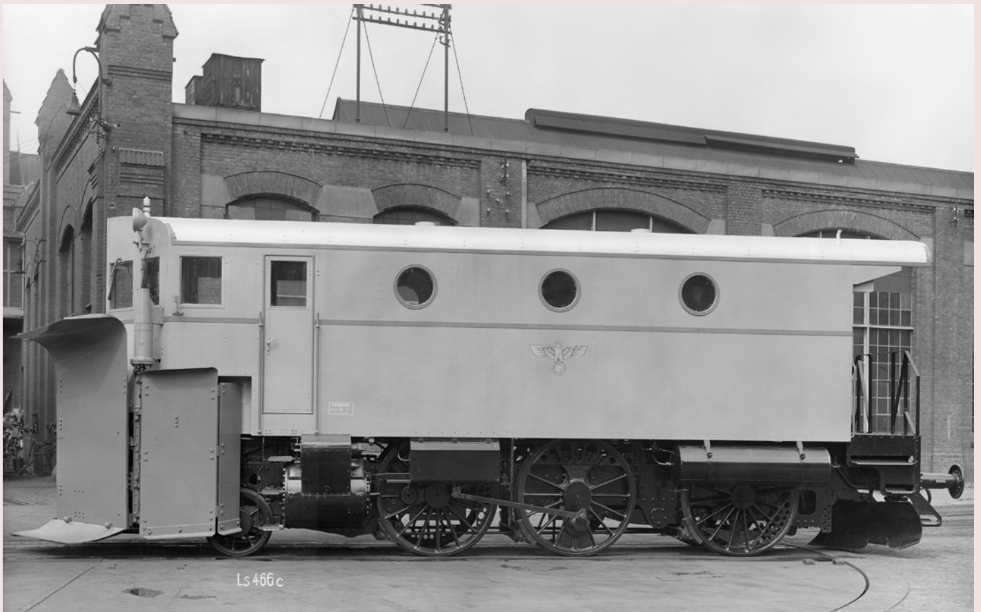
Der im Jahr 1941 von Henschel gebaute Klima-Schneepflug besitzt das Fahrgestell der kkStB Reihe 329. Werkfoto Henschel/Slg. Lothar Rihosek
