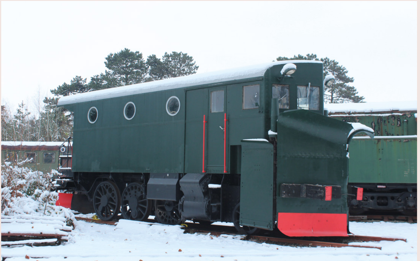
ÖBB Klima-Schneepflug, gebaut 1942 bei Henschel mit dem Fahrgestell der kkStB 30.104. Dieser war zuletzt als 976 0 200-2 in Amstetten stationiert und befindet sich nun im Eisenbahnmuseum Strasshof. Aufnahme vom 5. Dezember 2023. Lothar Rihosek
