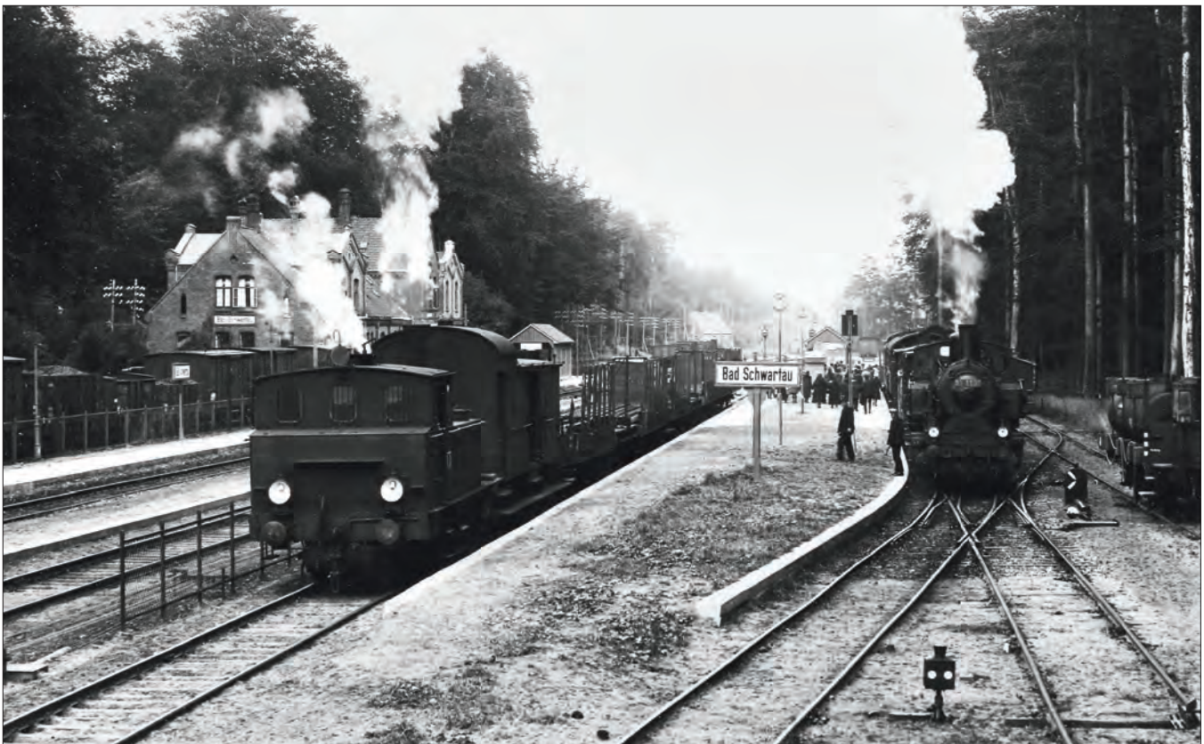
Im Sommer 1927 ist die preußische Güterzugtenderlokomotive 91 1100 der Deutschen Reichsbahn mit einem Personenzug aus Haffkrug auf Gleis 4 in Bad Schwartau eingetroffen. Reisende in Richtung Lübeck müssen hier in einen Zug der ELE, der in Kürze auf Gleis 1 einlaufen wird, umsteigen. Auf Gleis 3 wartet eine preußische T 4 (Eutin-Lübeck Nr. 3) mit „Falschfahrt-Spitzensignal“ (Signal Zg 2: Rote Scheibe mit weißem Rand) über dem mittleren Führerhausfenster vor einem Arbeitszug. Rechts ist der Bahndienstwagen für Fäkalien der ELE zu sehen.
